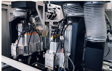
顶部钻包12垂直+8水平 Top Drill Bank: 12 vertical +8 Horizontal
