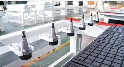
后置排式刀库，换刀简洁快速 Linear tool Changer
