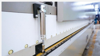
钢导轨+钢压梁
